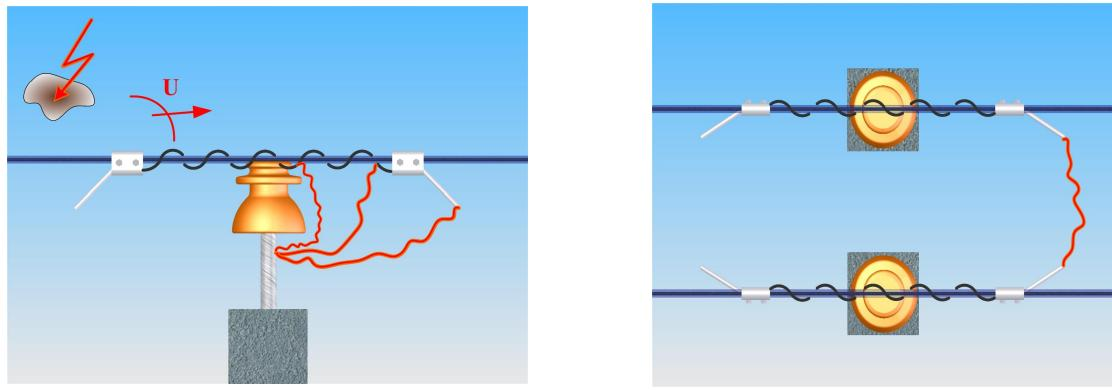
Рис.2 Принцип действия дугозащитных рогов
