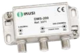
Частотный диплексер DMS-200. Потери: TV  $\leq 1,0$  дБ, SAT  $\leq 1,5$  дБ, развязка  $\geq 25$  дБ, ток транзита 18 В/500 мА (мак.)
